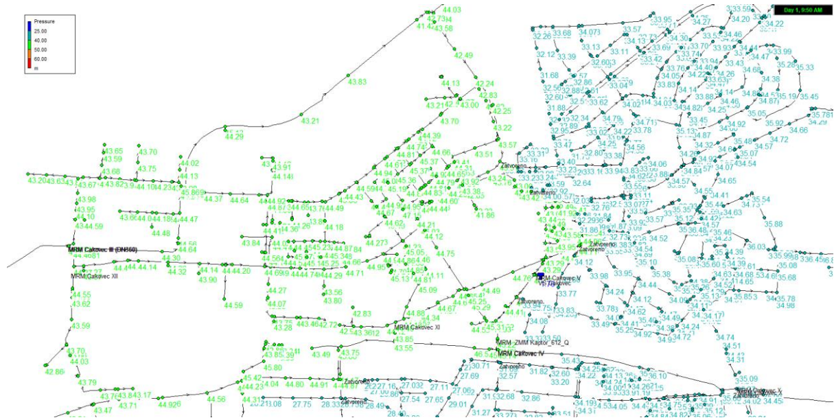
Slika 38. Raspodjela minimalnih tlakova u centralnom dijelu Čakovca za varijantu A
