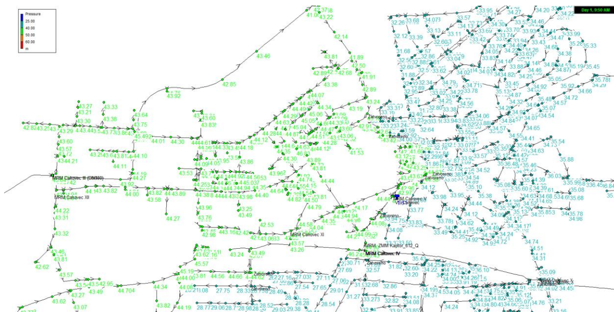
Slika 47. Raspodjela minimalnih tlakova u centralnom dijelu Čakovca za varijantu C
