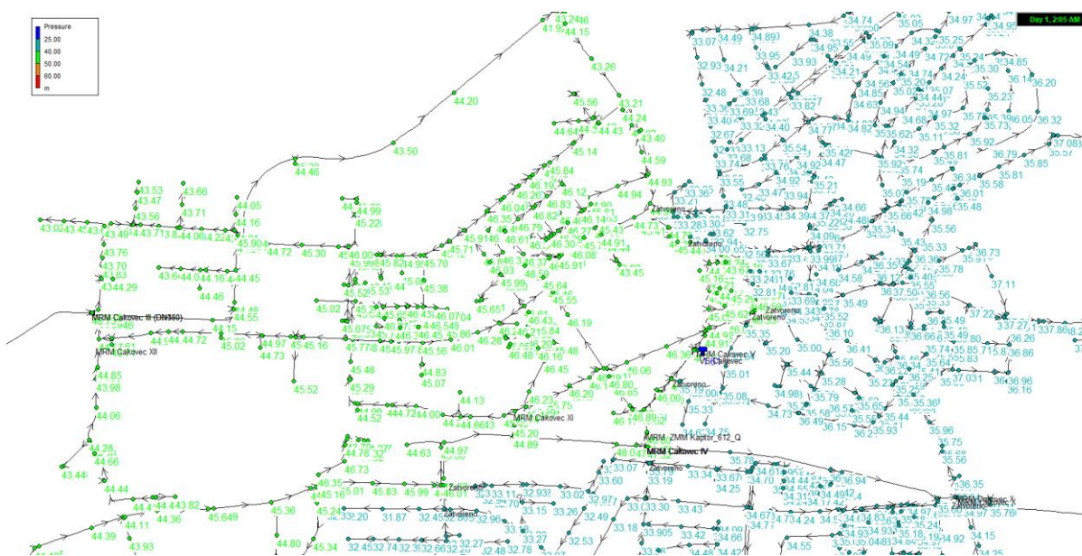
Slika 46. Raspodjela maksimalnih tlakova u centralnom dijelu Čakovca za varijantu C
